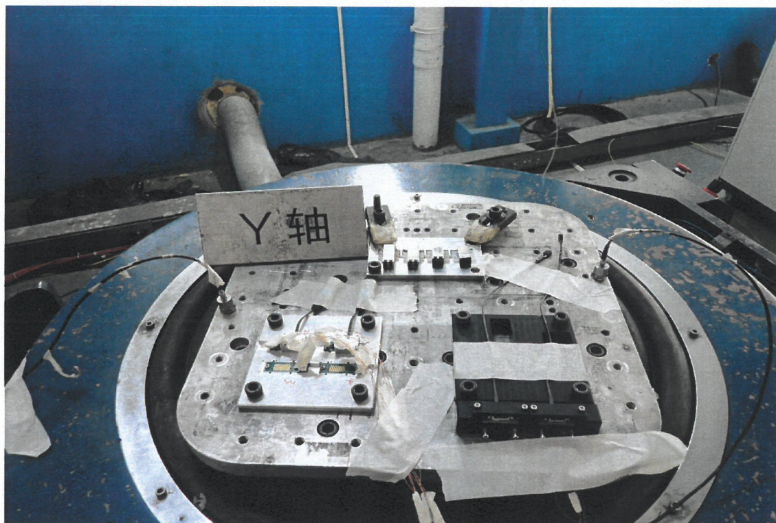
样品安装图-随机振动试验
