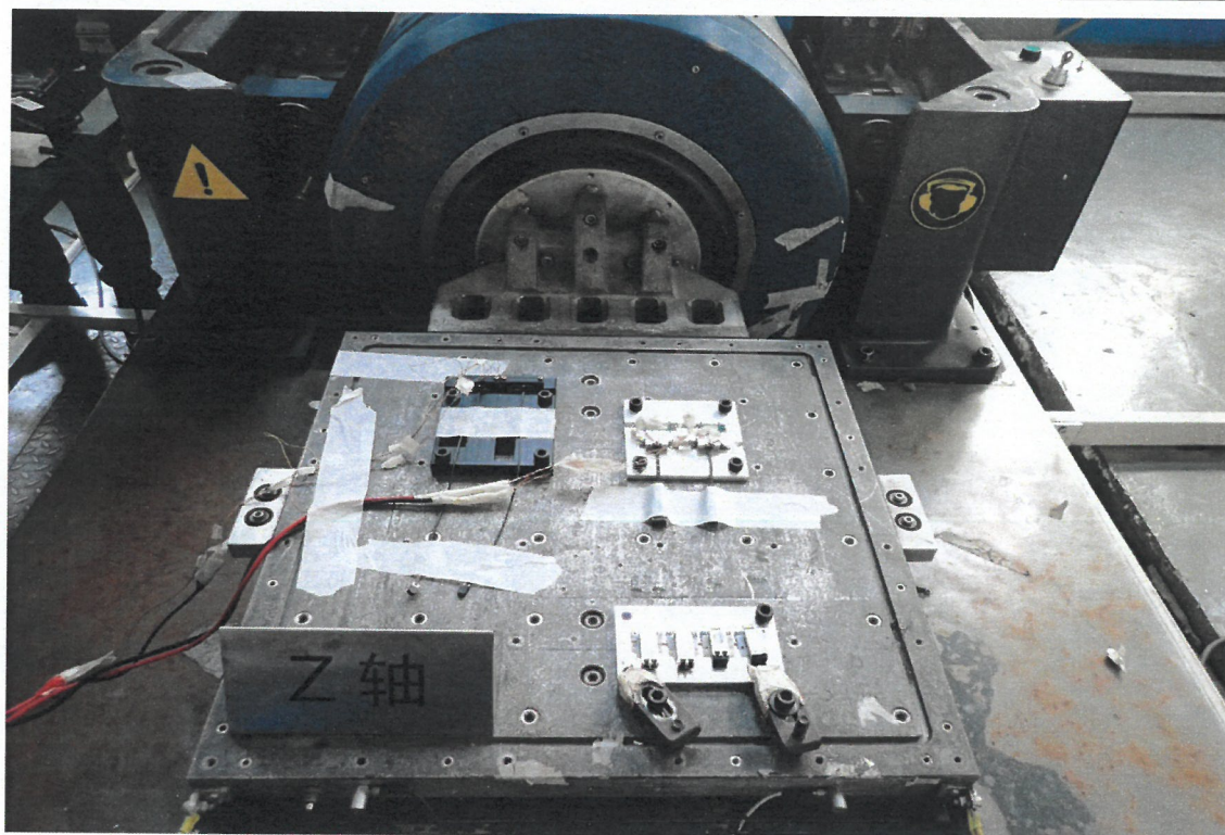
样品安装图-随机振动试验
