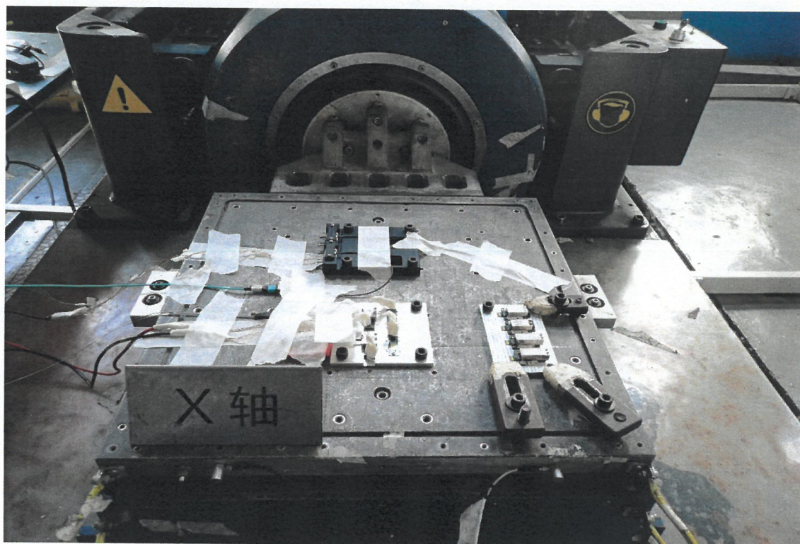
样品安装图-随机振动试验
